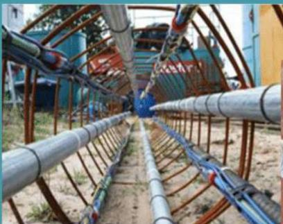
Figura 2: Armadura com *strain-gages* de corda vibrante instalados junto à armadura da estaca
