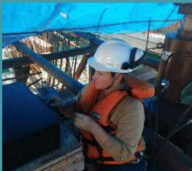
Figura 1: Execução de prova de carga estática instrumentada
